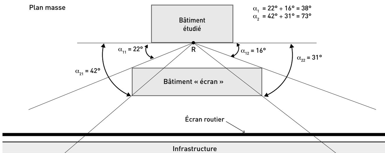
Dans l'exemple ci-dessus, la façade du bâtiment étudiée est protégée des bruits de l'infrastructure par un écran routier le long de l'infrastructure et par un bâtiment faisant écran. Pour la verticale passant par le point R de la façade étudiée, on détermine les angles  $\alpha$  sous lesquels l'infrastructure est encore vue (voir ci-dessus « Protection des façades considérées par des bâtiments »).
