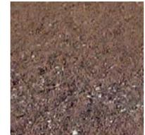
Pour le revêtement des allées et surfaces imperméabilisées, on pourra utiliser par exemple du béton désactivé, lissé, du Balthazar ou couches de graviers très fins sur un géotextile empêchant la profusion végétale
